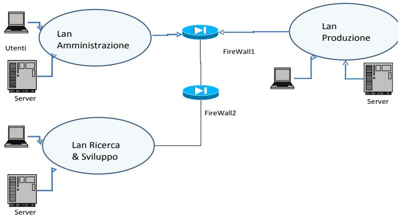
L'accesso ad Internet è controllato mediante un firewall (denominato firewall1) che filtra le comunicazioni secondo le regole decise. Un secondo firewall (denominato firewall2) separa la Lan “ricerca e sviluppo” dalle altre reti aziendali. Tutti i server e client sono dotati di antivirus aggiornati centralmente via Lan almeno giornalmente. Tutti i server sono dotati di gruppi di continuità e sistemi di back-up giornalieri automatici.
